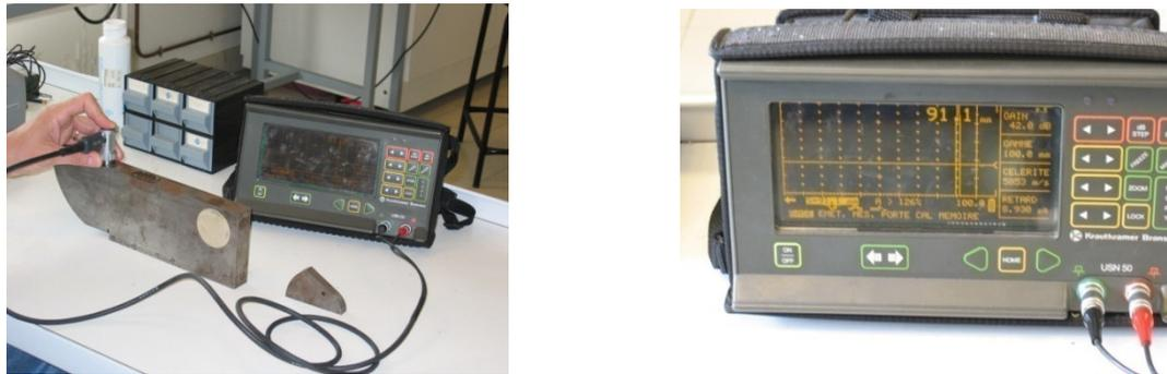
Figure 2.8. Mesure d'une fissure interne par ultrasons
